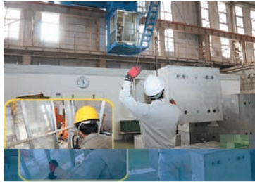
供試体の設置・運搬：クレーン・玉掛け
