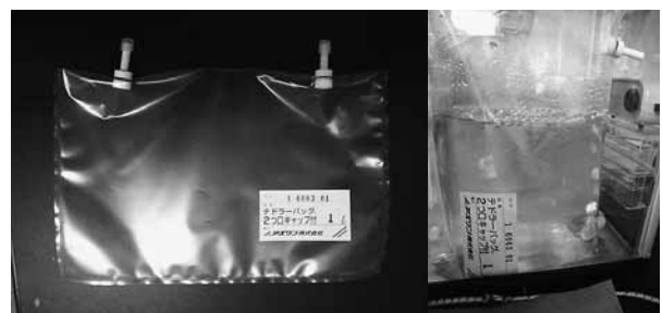
図12 エアレーション式 B（植物細胞培養用バッグ：アズワンテドラーバッグ2つ口キャップ付き1 ，リサイクル可能）
