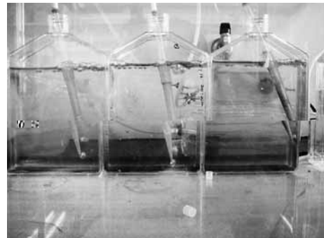
図11 エアレーション式 A（浮遊細胞培養用1 フラスコ縦置き）IWAKI 225cm 2 /non-treated flask（1143-225）をリサイクルして使用
