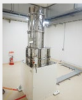
低線量率 ガンマ線照射装置 0.002 ~ 1.5mGy/min
